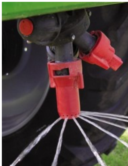
Rys. 1. Sposób działania rozpylacza wielostrumieniowego.
