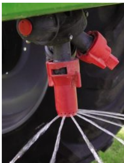
Rys. 1 Sposób działania rozpylacza wielostrumieniowego
